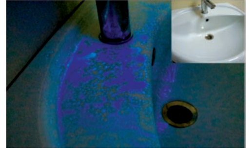
Şekil 3. Küçük resim gün ışığında temiz olduğu düşünülen bir lavabo. Büyük resim ise laboratuvarlarımızda sentezlenen luminol-tipi bir maddenin görünmeyen kan lekelerinde kullanımı; kanın olduğu bölgeler karanlıkta mavi renkte ışımaya başlıyor.
